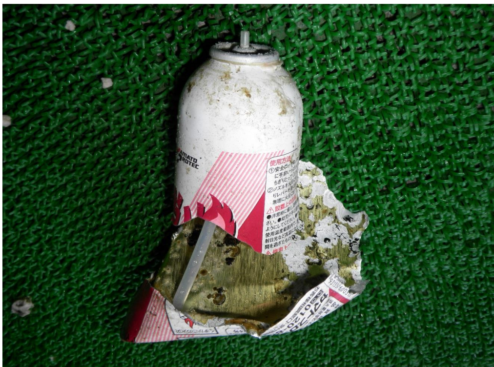
破裂したエアゾール式簡易消火用具を撮影したもの
