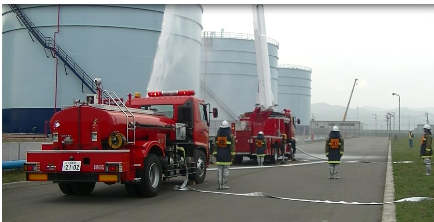
大型化学高所放水車の放水塔から放水
